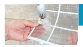
Laver les filtres à l'eau tiède. À l'aide d'un chiffon doux assécher les filtres. Une fois terminer remettre à l'intérieur de votre appareil.
